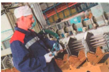
На Новосибирском заводе химических концентратов. Сварка конструкции для тепловыделяющих элементов с содержанием ядерного топлива, использующегося в АЭС (2015 г.)
